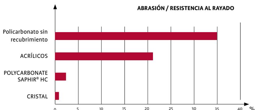
La prueba de abrasión muestra la disminución de la transparencia después de la abrasión. POLYCARBONATE SAPHIR® tiene propiedades similares al vidrio gracias a su recubrimiento protector.
